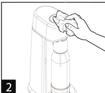
2. 可用濕布輕拭外殼，切勿將機器本體浸泡於水中清潔或使用任何具有溶解性或腐蝕性的洗劑清洗，因為這樣將會傷害外殼表面
