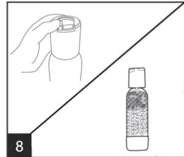
8.打開Fizz Infuser上的緩洩壓閥並且注意洩壓時氣泡的濃度如果氣泡溢出,請關上緩卸壓閥,待氣泡沉澱後再打開若氣泡仍是有快速溢出的狀況建議縮短按壓打氣按鈕的時間
