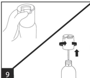
9.若打開洩壓閥的時候有發生氣體堵住無法洩出的狀況,請按藍色的快速洩壓按鈕,以確保壓力完全釋放出來可用逆時針的方式取下Fizz Infuser,切勿用力拔取
