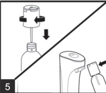
5. Fizz Infuser 順時針鎖緊於水瓶上，接著將Fizz Infuser完全扣入Fizz Infuser接頭中後輕壓Fizz Infuser使其固定於直立位置
