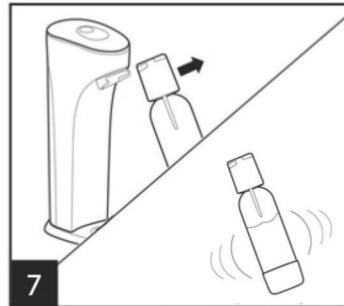
7.將Fizz Infuser和水瓶向前提拉至45度角即可取下,輕搖水瓶和Fizz Infuser可增加氣泡的濃度
